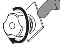
重要: (+) と (-) の Y ラグの端子部が互いに、あるいは他の端子と接触していないことをご確認ください。端子部に触れると回路がショートし、レシーバーまたはアンプが破損する可能性があります。
