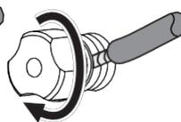
重要: (+) と (-) の線、またはピンが互いに、あるいは他の端子と接触していないことを確認してください。配線に触れると回路がショートし、レシーバーまたはアンプが破損する可能性があります。
